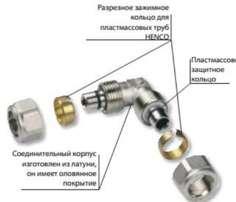
Латунные фитинги HENCO имеют корпус из высококачественной коррозионностойкой латуни CW617N/CW614N, имеют уплотнения из EPDM каучука, разрезное зажимное кольцо и гайки. В фитинге есть пластиковое защитное кольцо, которое исключает прямой гальванический контакт между металлом трубы и корпуса фитинга. Корпус фитинга покрывается никелем только снаружи не затрагивая резьбу с середины 2015 года. До этого применялось полное лужение фитинга.
